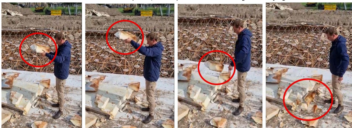
Video 1. Aantoonbare broosheid isolatie dekplaten, isolatieplaat breekt eenvoudig in kleine fragmenten
