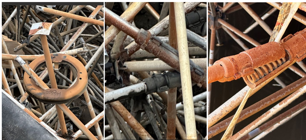
Fig. 8 (A) gebroken polyamide draagschijf en (B) expansieveer houders vastgezet met gegalvaniseerde metalen klem en/of polypropyleen tie-rop en (C) gebroken polyamide veerhouder
